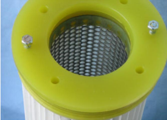
El núcleo central del cartucho está hecho de acero al carbono en lugar de plástico. Esto es crítico para el uso en plantas neumáticas donde el producto se mueve por vacío, en lugar de una fase diluida de presión positiva.
